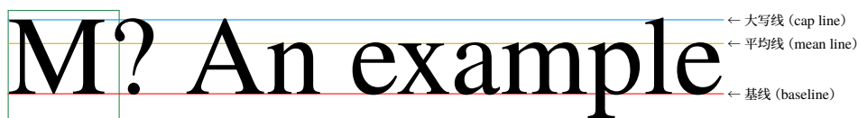
图 1：西文字体。绿色方框即为 em-box，它在纸上的实际边长就是西文字号。
